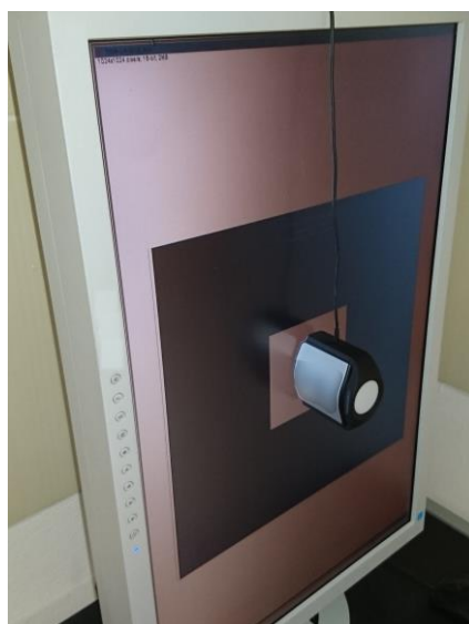
3.3.9.1a ábra: Mérési elrendezés a fénysűrűség méréséhez, a fénymérő éppen a monitor közepén látható
