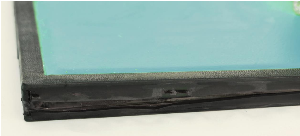
3.2.13.6 ábra: Elöregedett kazetta elgyengült zsanérja, ami fénybeszűrődést okoz
