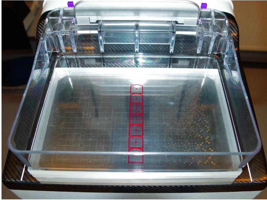
3.3.7.3 ábra: A fantom megfelelő pozicionálása
