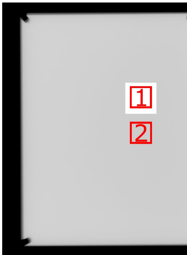
3.2.11.2 ábra: AEC ellenőrzése digitális mammográfoknál
